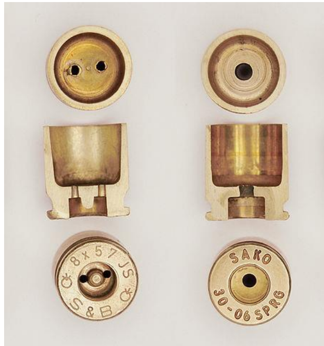
Capsules d'amorçages Berdan (à gauche) et Boxer (à droite)
