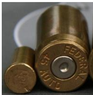
Percussion annulaire (à gauche) et centrale (à droite)
