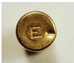
Percussion annulaire sur une douille de calibre .22
